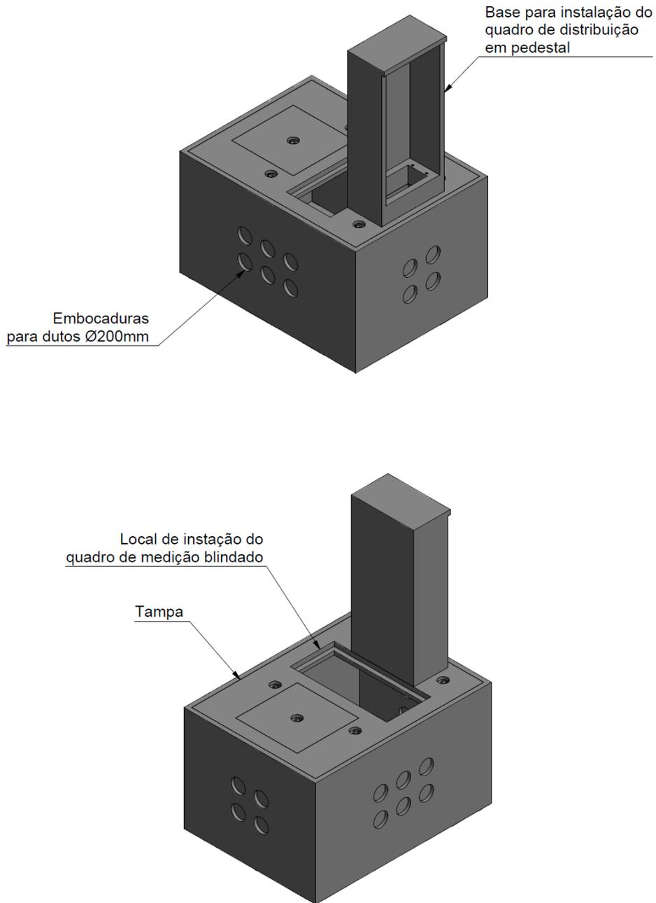
**Figura 2** - Base de concreto para conjunto de medição agrupado blindado: Vistas isométricas
