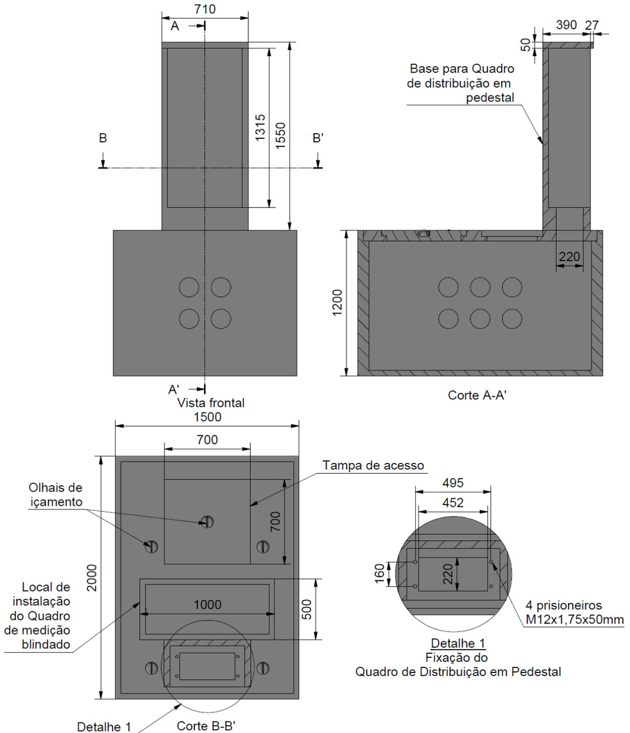
**Figura 1** – Base de concreto para conjunto de medição agrupado blindado
